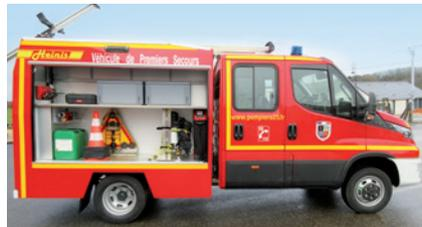
▲ VPS : 160 CV, pompe hydraulique 600 litres
