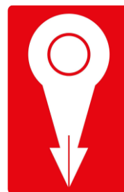
Disque avec flèche signalant un point d'eau utilisable (exemple)
