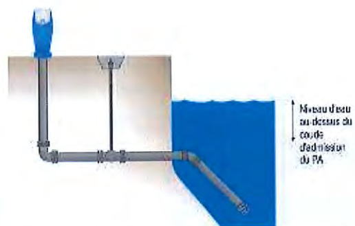
PA classique alimenté par une réserve enterrée
